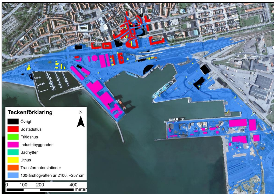
Figur 4-9 Byggnader som riskerar att översvämmas vid ett 100-årshögvatten år 2100 i Ystad hamn och marina.
