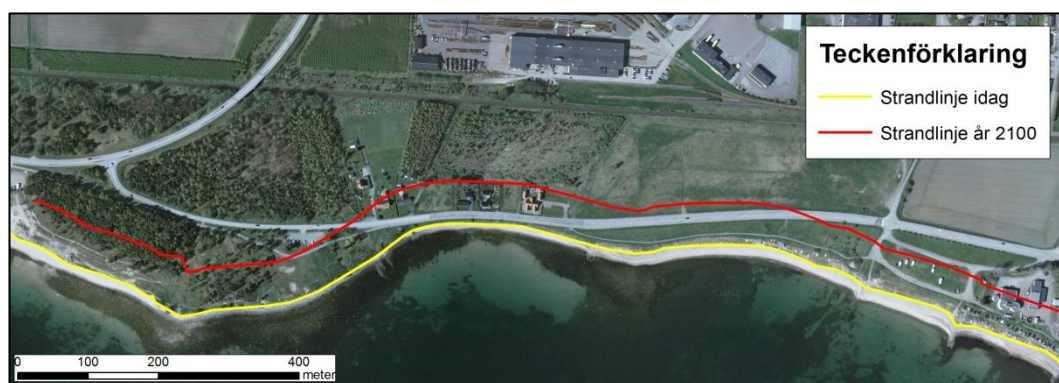
Figur 4-2 Strandlinjeförflyttning fram till år 2100 enligt Bruuns lag vid strandavsnitt A – Väster om reningsverket.
