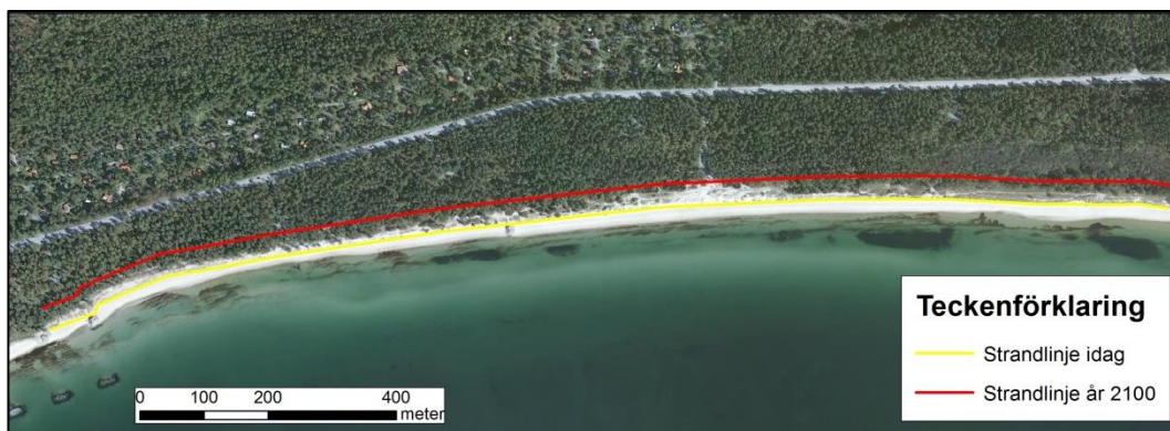
Figur 4-5 Strandlinjeförflyttning fram till år 2100 enligt Bruuns lag vid strandavsnitt H – Ystad sandskog öster.
