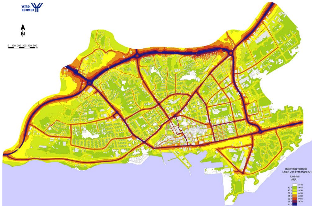
Kartläggning av vägtrafikbuller i Ystads tätort. Orange, röda och lila områden visar på bullernivåer över riktvärdena för god miljö kvalitet (55 dB(A) ekvivalent nivå).
