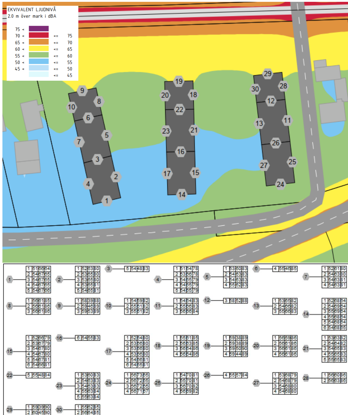
Figur 3. Urklipp ur bilaga AK01. Beräknade nivåer från väg- och järnvägstrafik, prognosår 2040. Tabellerade värden avser frifältsvärden och avläses "Våning / Leq / Lmax väg / Lmax Järnväg".
